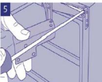
Mit dem oberen Scharnier geöffnet, die Schrauben entfernen, mit der sie am Schrank befestigt sind. Bitte gehen Sie mit dem Scharnier vorsichtig um und verwenden Sie einen Schraubendreher mit langem Stiel.
