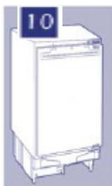
Prüfen Sie, ob die Einbaukühlschranktür horizontal und vertikal fluchtet und ob die Türdichtungen auf allen Seiten richtig abdichten, bevor Sie die Scharnierrahmenschrauben festziehen.
