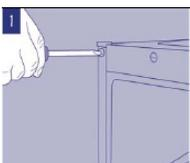
Die Blendplatten auf der Außenseite der Einbauschranktür entfernen.
