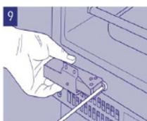
Die Tür wieder einsetzen und die Scharniere anschrauben.
